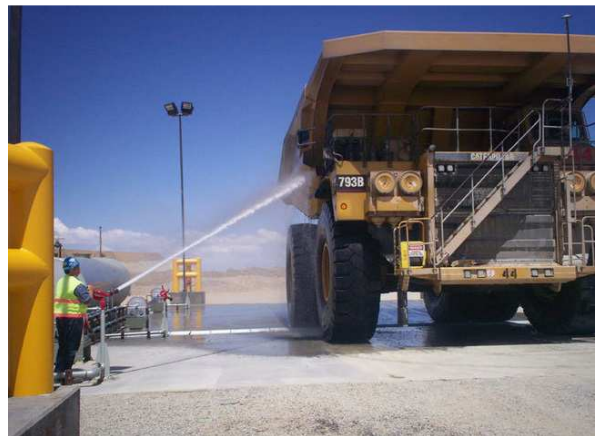
Bild 2. Manuell tvätt av arbetsfordon inom gruvindustrin (Tammermatic Group, 2016)
