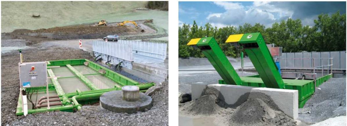
Bild 8. En vattentank som renas manuellt med till exempel en grävmaskin, och till höger, en vattentank med helautomatisk slamrening bestående av skrapa och transportband (Frutiger, 2016).
