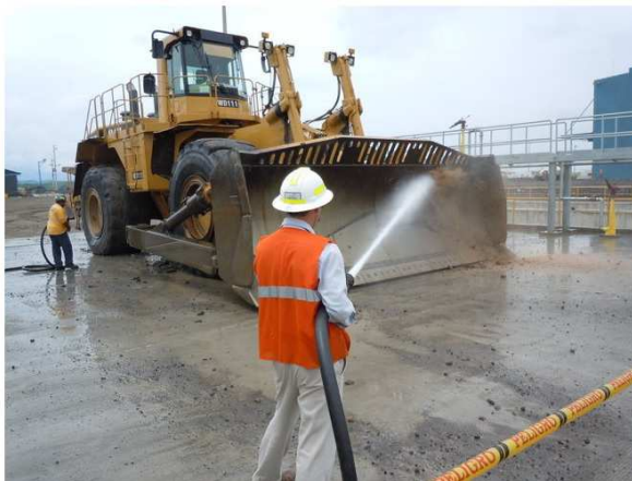
Bild 2. Manuell tvätt av arbetsfordon inom gruvindustrin (Tammermatic Group, 2016)
