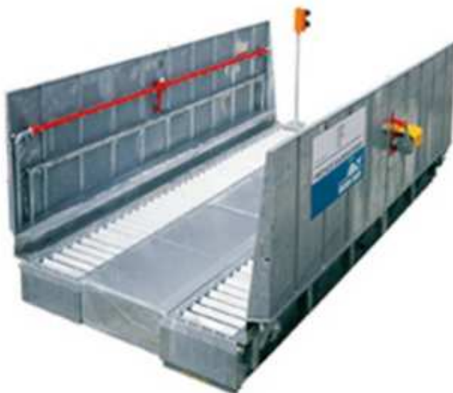
Bild 9. En drive-through som tvättar med stor volym vatten vid lågt tryck (Frutiger, 2016)
