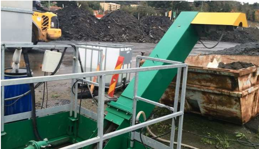
Bild 15. Här syns transportbandet för automatisk transport av bottenslam till intilliggande container.
